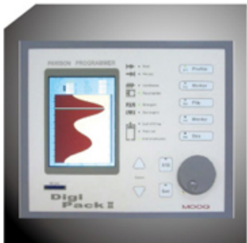
MOOG 100/400 點厚薄控制器 MOOG 100/400 POINTS PARISON CONTROL
