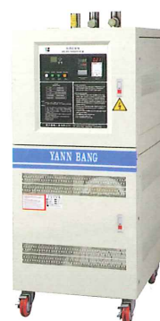
除溼乾燥機 Dehumidifier (3HP)
